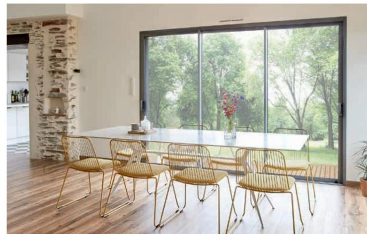
Coulissant 3 vantaux 3 rails - permet une ouverture à 2/3.
