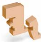
Tapée intérieure rapportée pour isolation de 80 mm
